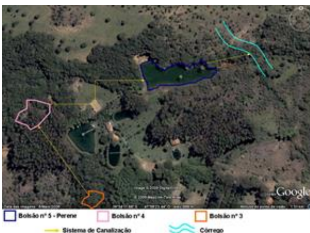
Figura 6 Sistema de canalização dos bolsões.
